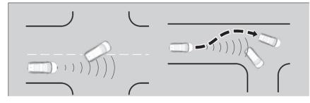
■Collision Mitigation Braking System<sup>™</sup> (CMBS<sup>™</sup>)
