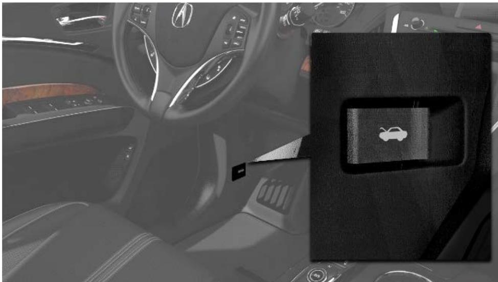
2. Repérez la détente d'ouverture du capot, poussez la détente et soulevez le capot.
