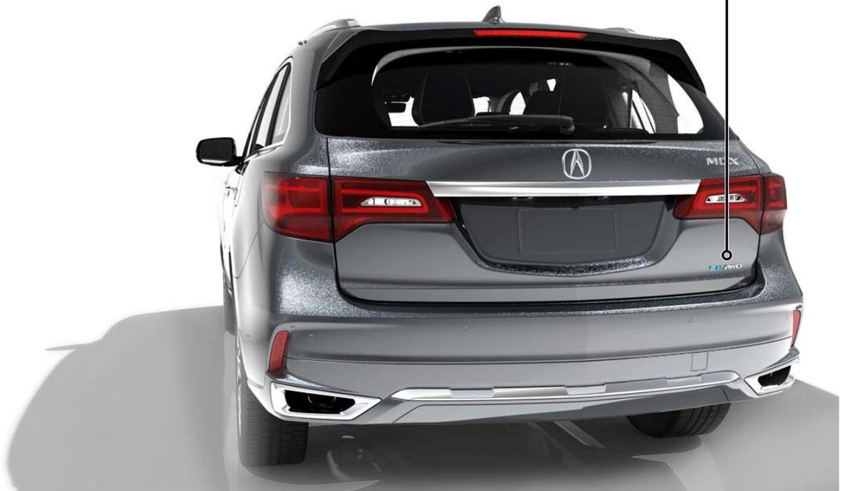
Un véhicule Acura MDX Sport Hybrid 2017 à 2020 peut également être identifié en vérifiant le NIV aux trois endroits indiqués plus bas. Les caractères 4 à 6 du NIV seront **YD7**, indiquant qu'il s'agit d'un modèle Acura MDX Sport Hybrid.
