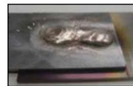
Sans soudure MIG pulsée (inacceptable)
