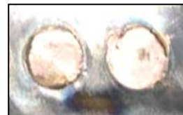
Sans soudure MIG pulsée (inacceptable)
