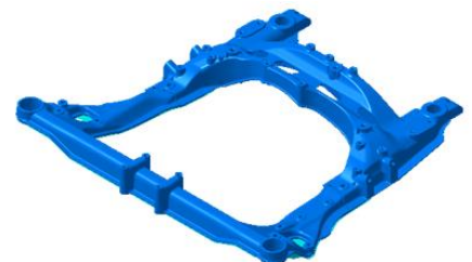
Sous-cadre avant entièrement en aluminium
