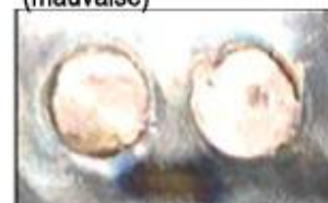
Sans soudure MIG pulsée (mauvaise)
