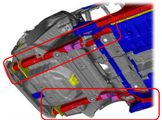
Rails de châssis arrière en acier de 1 500 MPa
