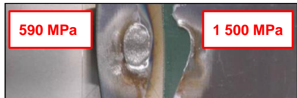
Résultats du test de résistance à la traction de l'acier de 1 500 MPa soumis au soudage MAG
