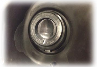
Système de ravitaillement en carburant sans bouchon
