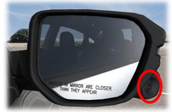
Emplacement de la caméra du système LaneWatch
