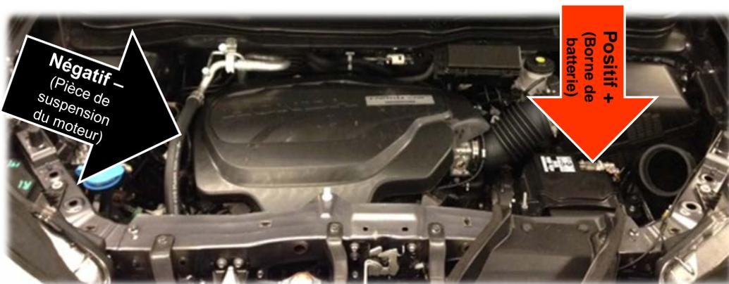
Positions de démarrage de secours/recharge/essai de la batterie de 12 volts sous le capot.
