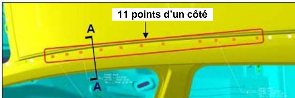
Zone de soudage par points des quatre plaques du panneau de toit
