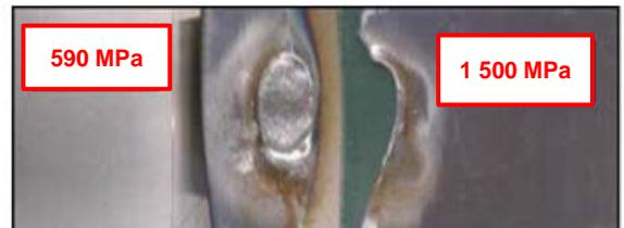
Résultats de l'essai de résistance à la traction de l'acier de 1 500 MPa soumis au soudage
