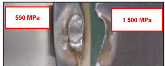
Résultats de l'essai de résistance à la traction de l'acier de 1 500 MPa soumis au soudage MAG
