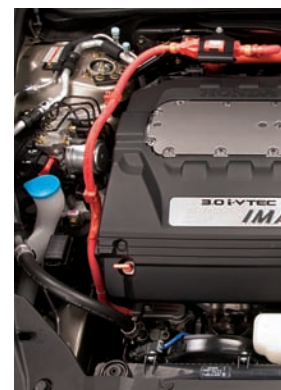
Câble haute tension du compresseur du climatiseur de l'Accord
